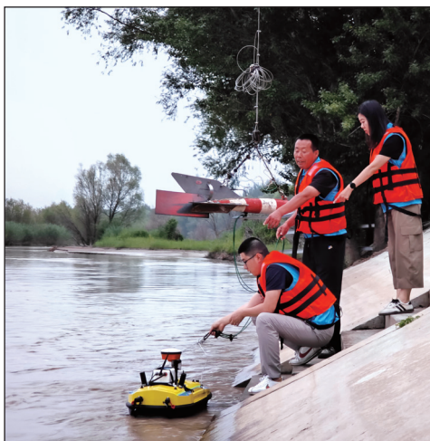
官厅水库管理处进行ADCP测流
